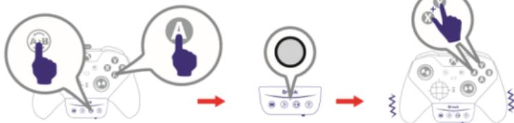
Если зажать Переназначение и А, отпустить, затем нажать одновременно X+Y, на А будет назначено X+Y
